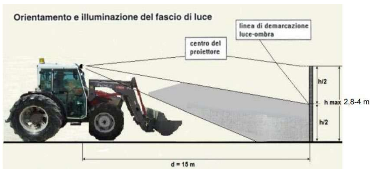
Figura 1 – Orientamento del fascio di luce per fari con altezza del centro ottico “h” superiore a 1,5 m e inferiore a 4,0 m
